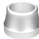
087510 AREJADOR ENCAIXE ABS Arejador Encaixe para Tubo de Torneira 5/8 (15,8mm) Converte Tubo de Encaixe para Rosca Interna Material: ABS
