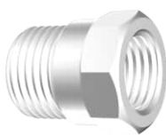
089602 Rosca Externa: 3/8" ADAPTADOR PARA FILTRO 1/4" X 3/8" Rosca Interna: 1/4" Acabamento: Cromado
