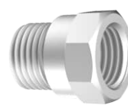
089604 Acento Vedação para Flexível ADAPTADOR PARA FILTRO EUROPA Padrão Europa Rosca Externa: 5/8" (Europa) Rosca Interna: 1/4" Acabamento: Cromado
